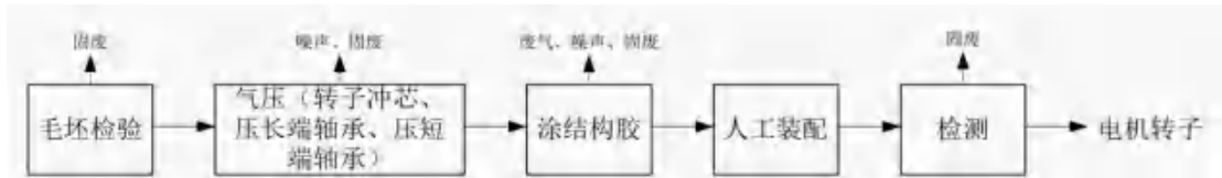
图3-4 转子组件总成装配工艺流程及产污节点图
